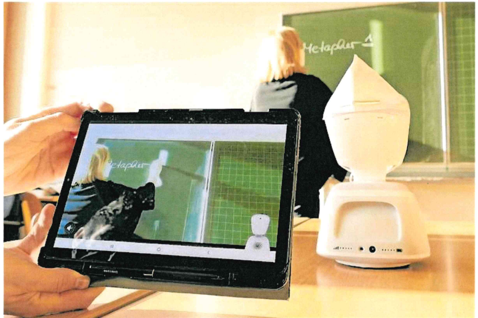
Über eine App am Tablet wird Julia gesteuert. Der Kopf mit integrierter Kamera ist frei beweglich. Auch das Aufzeigen ist dank LEDs darüber möglich. FOTO: EBENER
